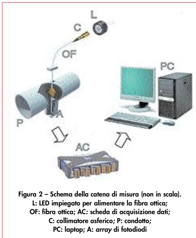
Figura 2 – Schema della catena di misura (non in scala).
